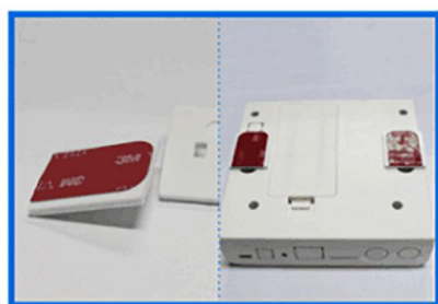
1. 将壁挂扣安置在壁挂孔上
