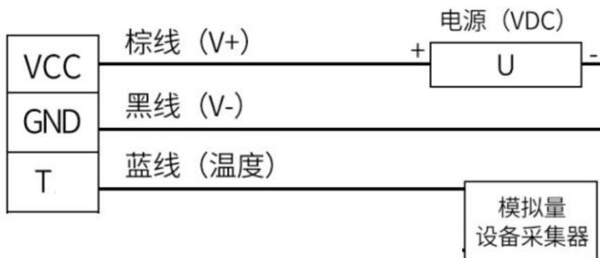
模拟量接线示意图
