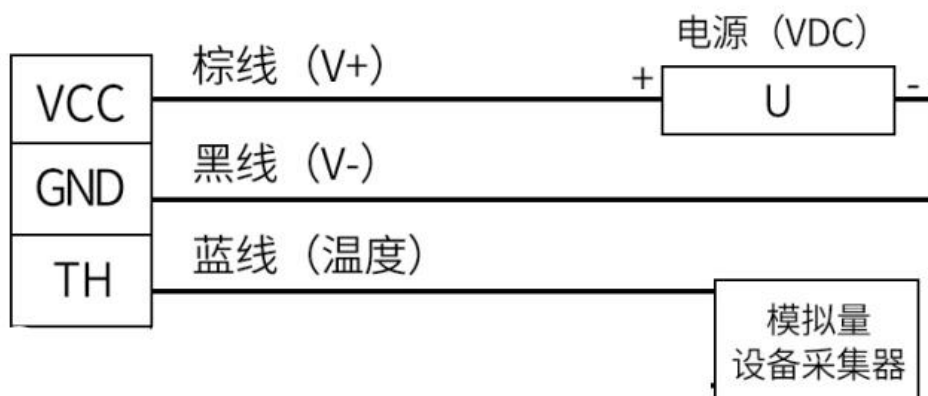
模拟量接线示意图
