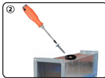
用螺丝将法兰盘固定在排风管上
