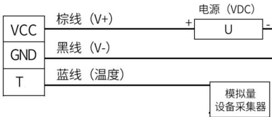
模拟量接线示意图
