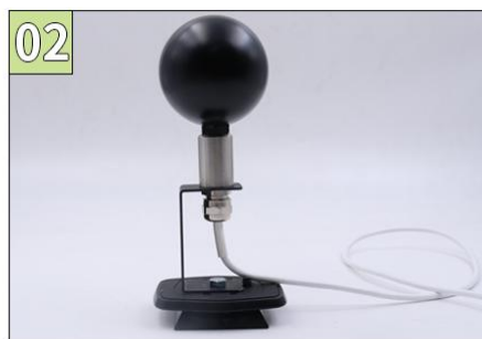
2.使用配套的螺钉螺母，将黑球以及支架安装到底座上
