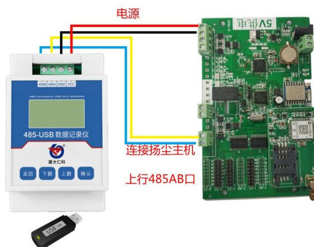
连接扬尘主机示意图
