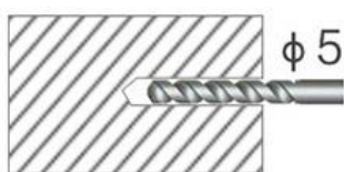
▲ 钻孔(孔径5mm)
