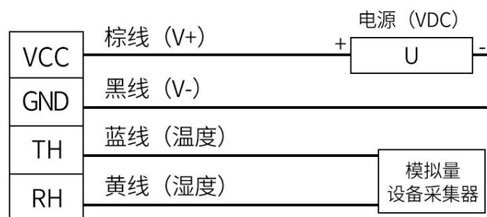
模拟量接线示意图
