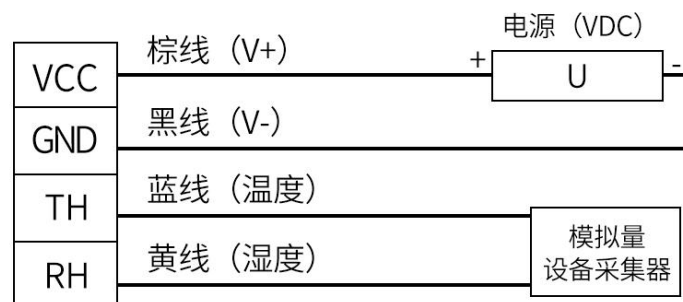
模拟量接线示意图
