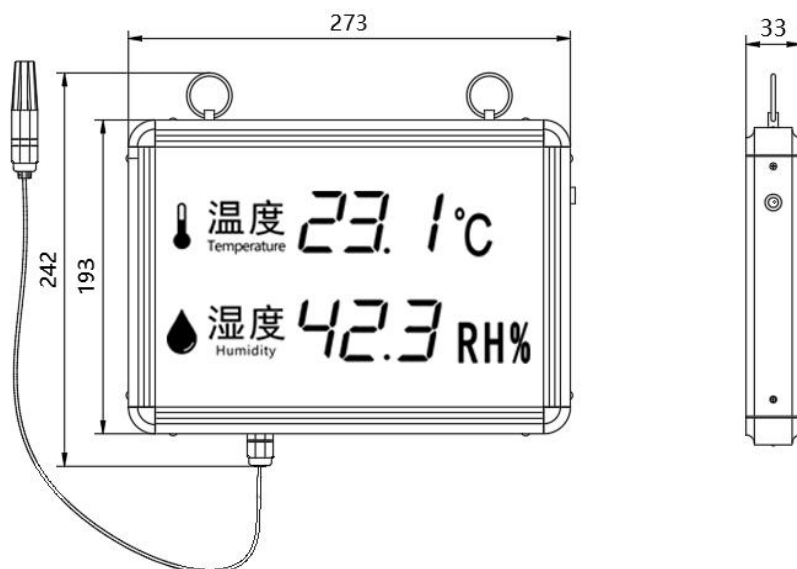
外延探头尺寸图 (单位: mm)
