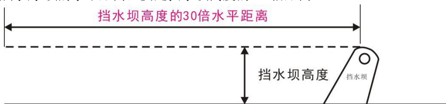
离开挡水坝高度 30 倍水平距离安装
