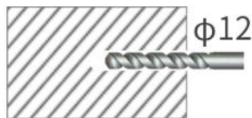
▲ 钻孔(孔径12mm)
