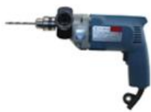
▲ 钻孔(孔径12mm)
