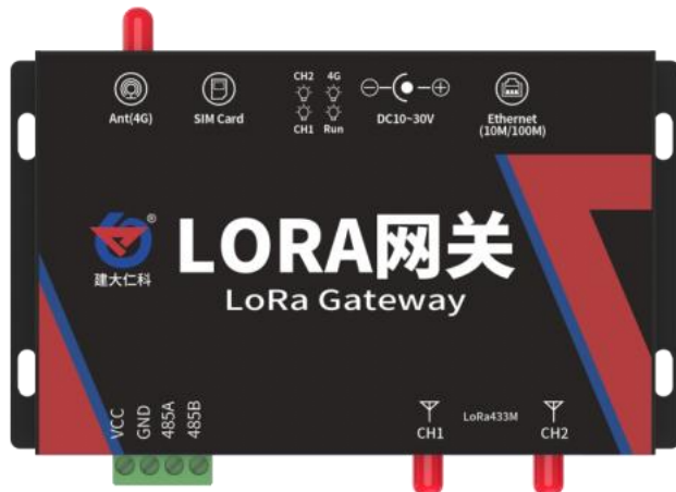
RS-LG-200 LORA 网关
